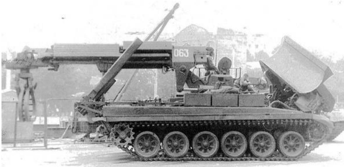
*Рис. 32. Инженерная машина разграждения ИМР-2*
