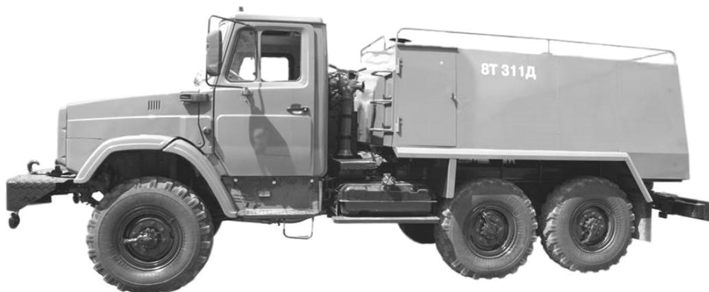
*Рис. 18. Обмывочно-нейтрализационная машина 8Т311Д (ЗИЛ-4334)*
