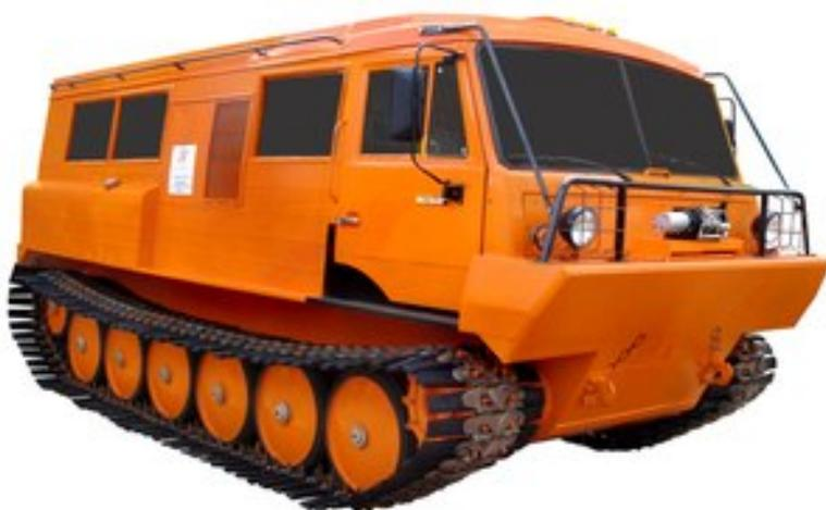
*Рис. 78. Внешний вид снегоболотохода ТТМ-3902 ПС (Тайга)*
