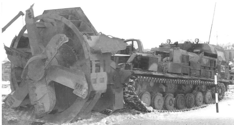
Рис. 31. Котлованная машина МДК-2
