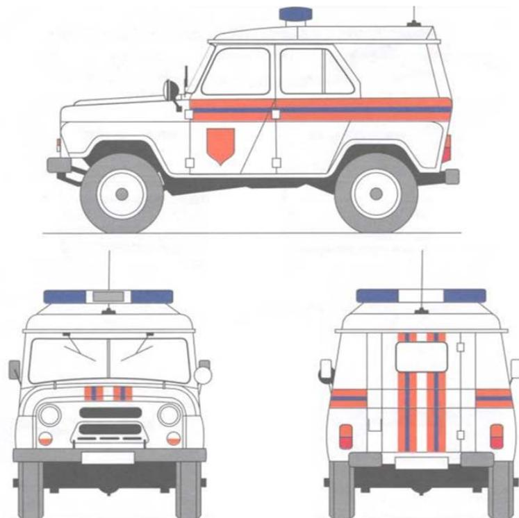
*Рис. 1. Цветографическая схема оперативных автомобилей служб предотвращения и помощи при чрезвычайных ситуациях и гражданской защиты на базе УАЗ-3151 (основной цвет автомобиля – белый, полоса оранжево-синяя)*
