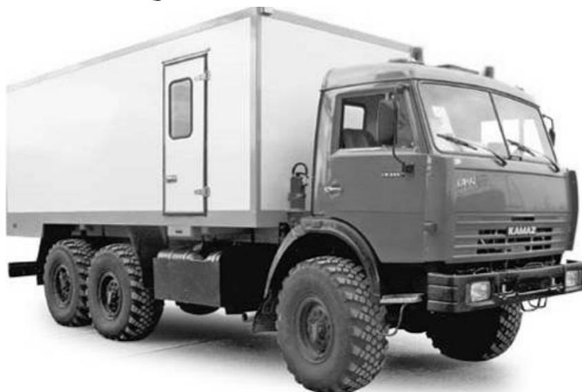
*Рис. 20. Передвижной склад взрывчатых материалов ПСВМ-2(4311)*
