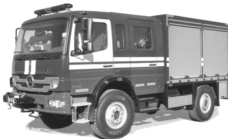
*Рис. 17. Автомобиль химической и радиационной безопасности радиационной разведки АХРБ-9(911)*
